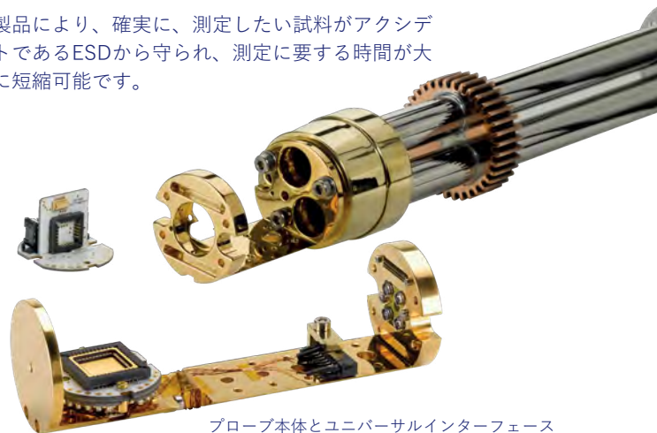
プローブ本体とユニバーサルインターフェース ピエゾ素子、試配置切替ホルダ。
